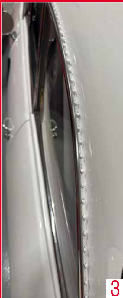
1, 2, 3, 4: Le fasi di restauro della parte telaio, in acciaio, e carrozzeria, in Peralluman, poi collegate tramite rivetti ben visibili nelle canaline di scolo del tetto e del cofano motore.
