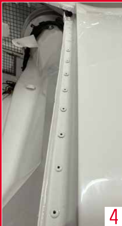
1, 2, 3, 4: Le fasi di restauro della parte telaio, in acciaio, e carrozzeria, in Peralluman, poi collegate tramite rivetti ben visibili nelle canaline di scolo del tetto e del cofano motore.
