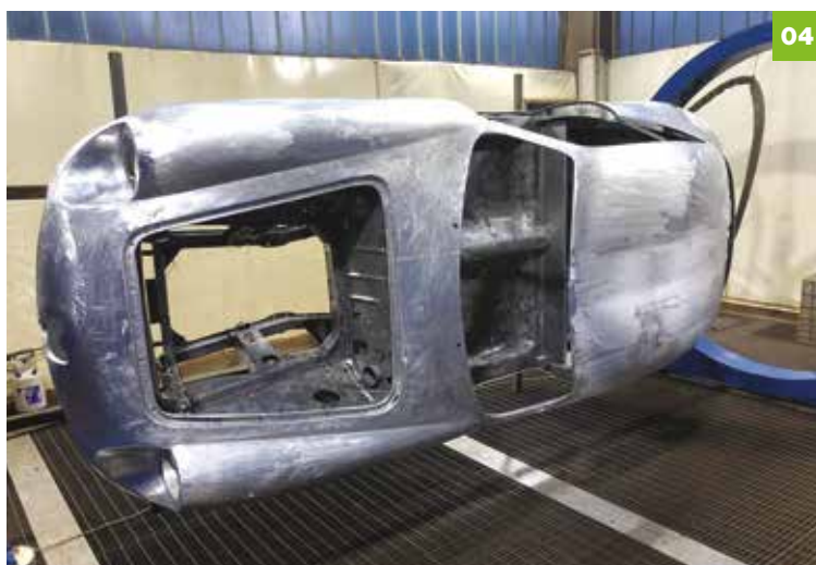
01, 02, 03, 04, 05, 06: La SVZ, a parte la differenza del frontale, con i gruppi ottici alloggiati nell'incavo anteriore dei parafanghi, presentava la carrozzeria in alluminio solo in parte danneggiata dalla corrosione, che invece aveva colpito in maniera più profonda il telaio e le parti in acciaio, come evidenziato dopo la sverniciatura.
