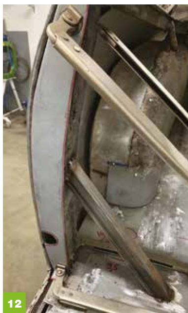
12, 13, 14: Più importanti gli interventi sulla parte in acciaio della scocca, con in particolare da sostituire modellati a mano anche in questo caso.
